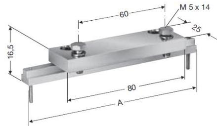
(コンパクトハンガー KA15/6 と使用した場合走行路取付面とコンダクターレール接触面までの距離: 24mm)
