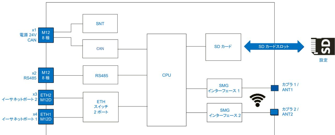
vCOM インターフェースには、管理(固定側)および/または付随する IO デバイス(可動側)に接続するためのイーサネットベースのインターフェースがあります。SMGM と SMGX は、PROFINET-IO と PROFIsafe の両方の伝送に最適化されています。
