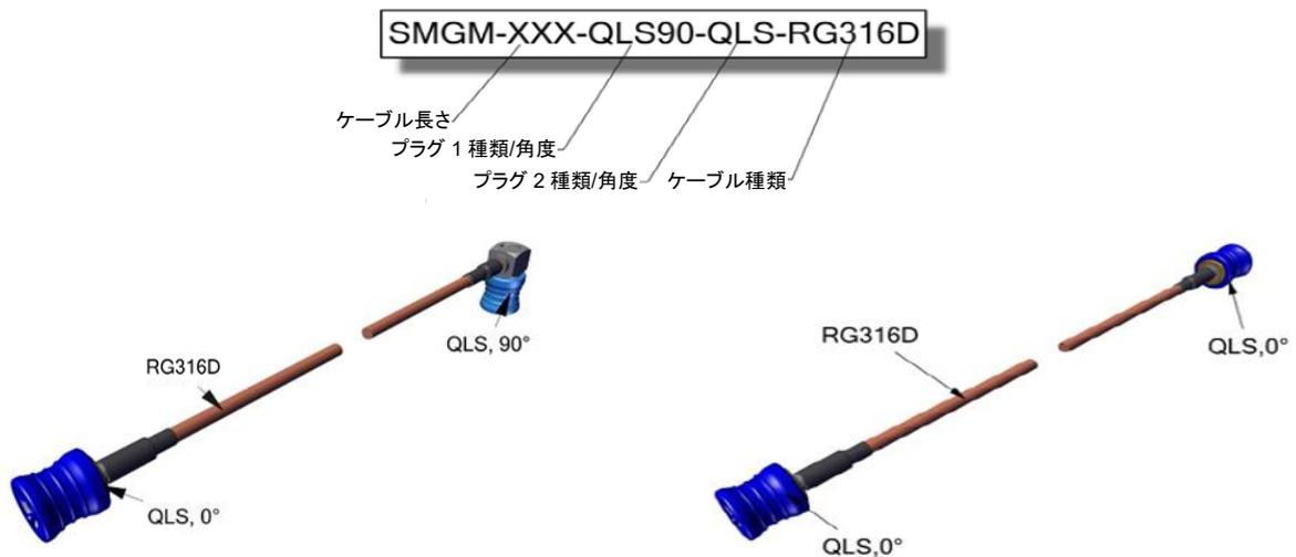
図 6-6 接続ケーブルの種類
