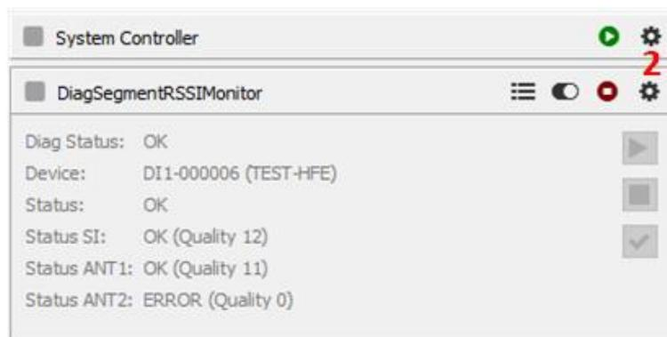
設定シンボル「2」をクリックして「Diag-Segment RSSI Monitor」を開きます。
